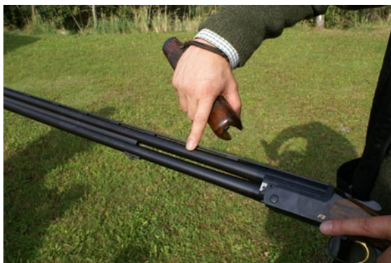
Blaser F3 Competition: „Das Laufbündel ist so gefertigt, dass sich beim Heiß-Schießen der Flinte keine Spannungen zwischen den Läufen bilden.“
